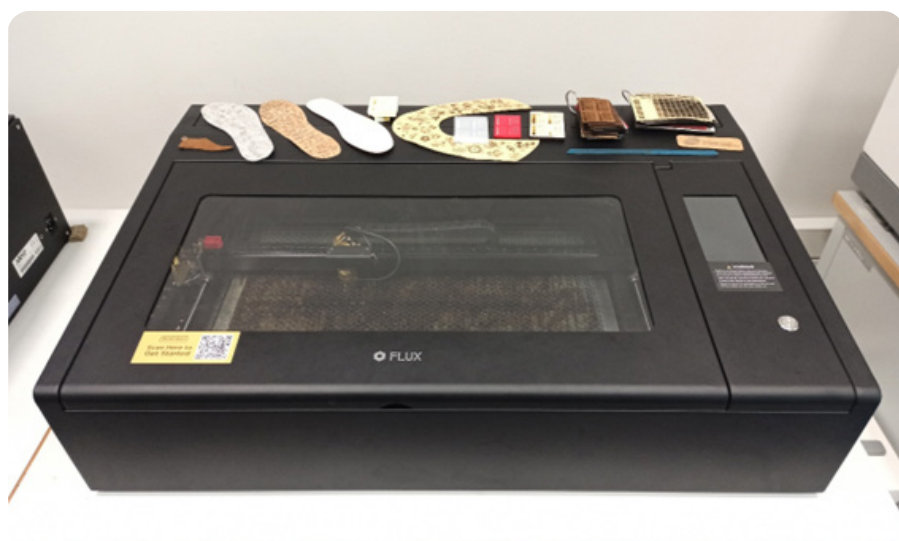
Figura 19 Equipamento de corte e gravação a laser Flux, disponível nas instalações do CTCP.
