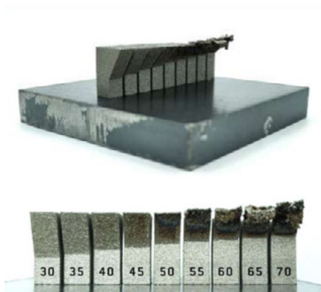
Figura 31 Experiência de impressão de saliências com diversas inclinações para estudo de limitações de design.
