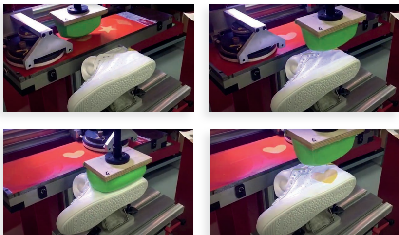
Figura 7: sequência do processo de tampografia. [18]
