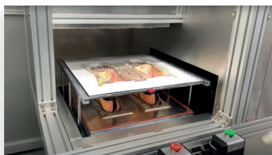
Figura 4: Processo de sublimação em sapatilhas. [12]
