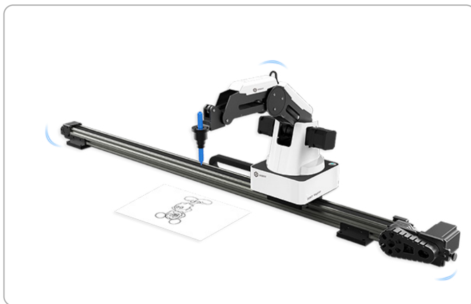
Figura 10 Dobot Magician montado em calha rolante [26].
