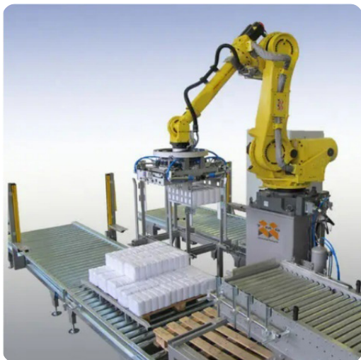
Figura 3 Célula Robotizada de Paletização [18].
