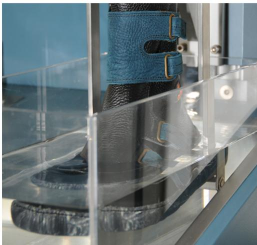
Figura 4 – Equipamento para avaliação da resistência à água do calçado completo.
