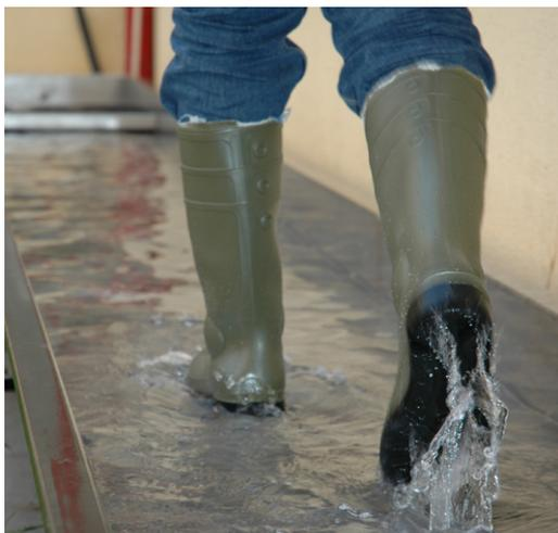
**Figura 3 – Vala para determinação da resistência à água do calçado completo**
