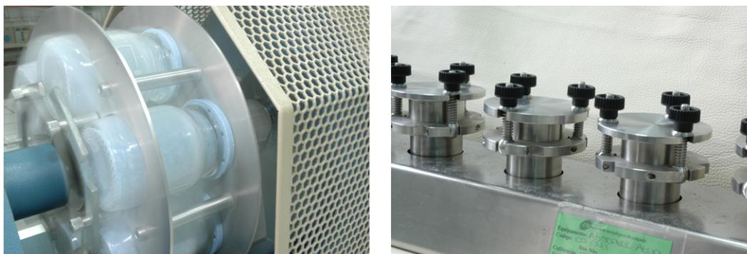
Figura 5 – Equipamento para avaliação da permeabilidade ao vapor de água
